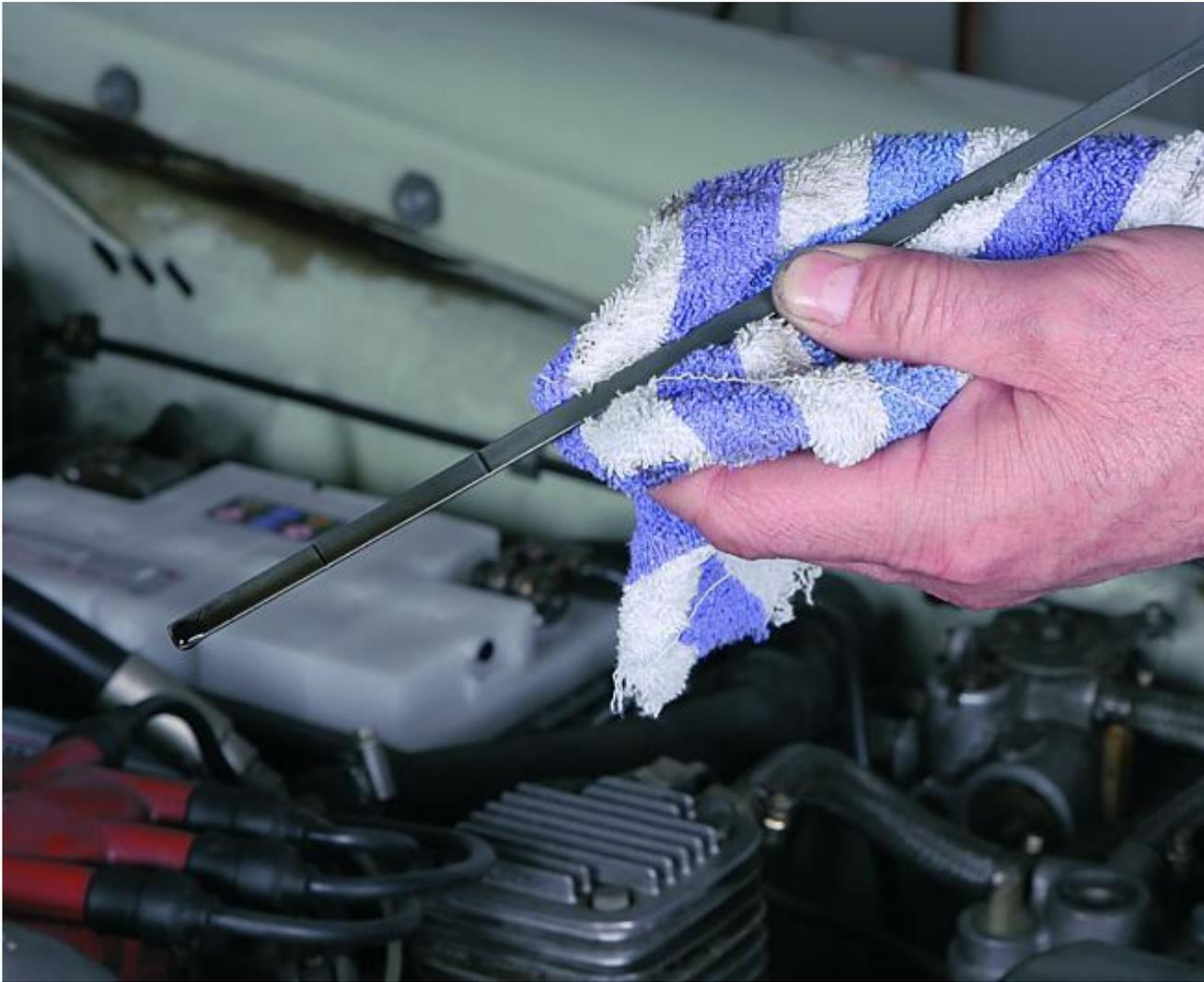
2. Öl: Kontrollieren Sie den Stand des Motoröls. Heller Schmierstoff am Peilstab ist ein gutes Zeichen. Stieg der Ölstand über Winter ohne eigenes Zutun plötzlich über die Maximum-Markierung, ist möglicherweise Kraftstoff ins Kurbelgehäuse gelangt. Eine Geruchprobe gibt hier Aufschluss
