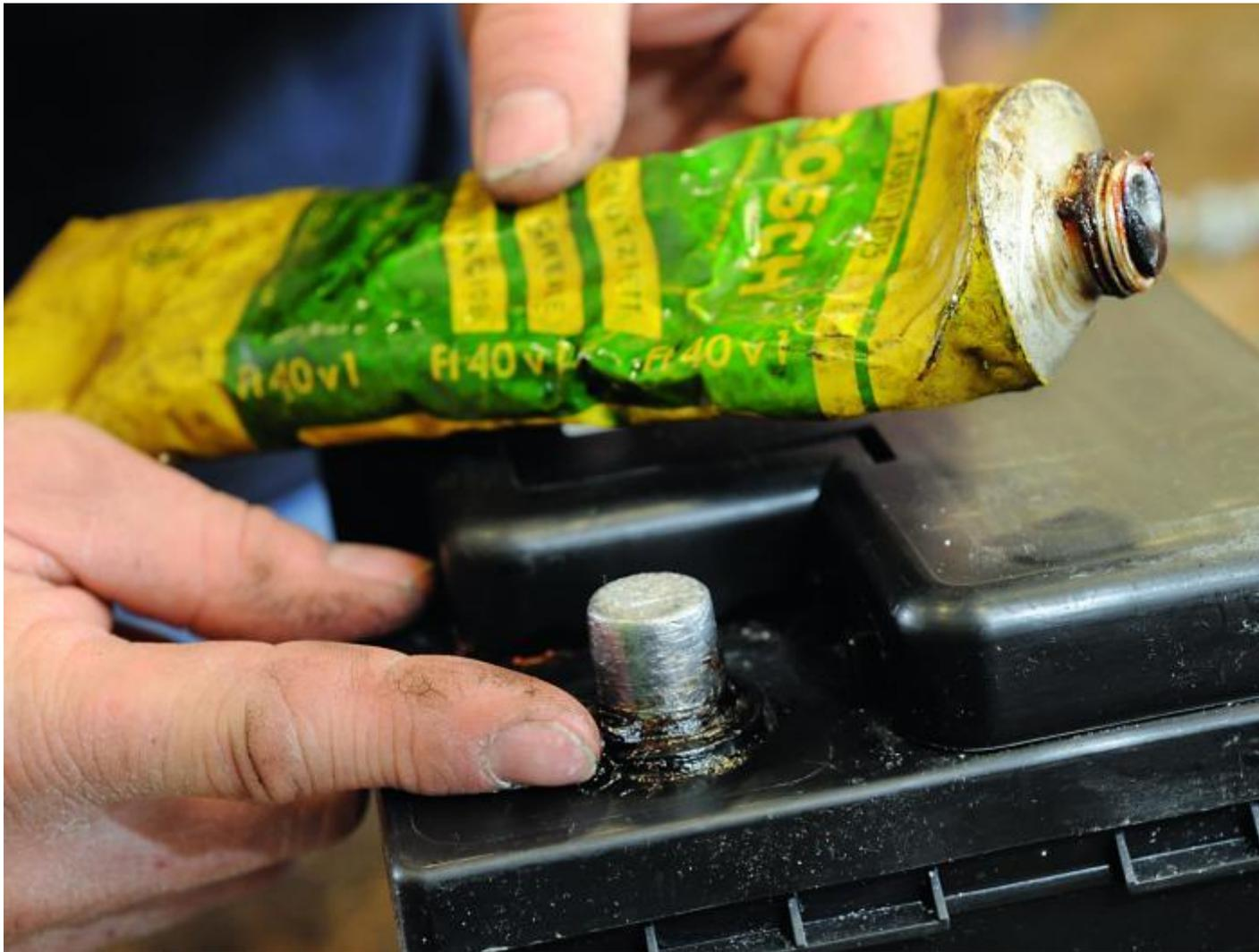
Sowohl Pole als auch Klemmen der Batterie müssen blitzsauber sein, damit keine Verkrustungen oder Ausblühungen den Stromfluss behindern können. Bei Batterien mit Verschlussstopfen sollten Sie zudem prüfen, ob destilliertes Wasser nachgefüllt werden muss. Achten Sie beim hantieren mit Säure auf adäquate Schutzkleidung!
