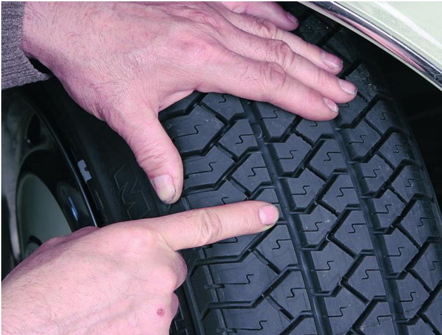
1. Am besten fangen Sie ganz unten an: Kontrollieren Sie den Reifendruck. Bringen Sie die Pneu wieder auf den vorgeschriebenen Druck (Reserverad nicht vergessen)
